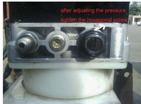
4) После регулировки давления затяните черную контргайку.
