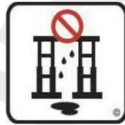
Не эксплуатируйте подъемник, если обнаружите утечку гидравлической жидкости в зоне подъема. Не эксплуатируйте неисправный подъемник
