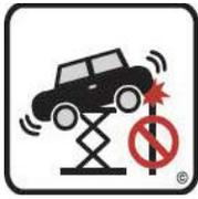
Не устанавливайте никаких подпорных шестов под автомобилем и опустите его при необходимости снятия детали с поднятого автомобиля
