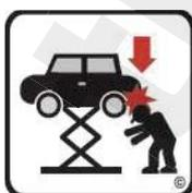
Не стойте под автомобилем во время работы подъемника. Если подъемник зафиксирован для работы в сравнительно низком положении, есть риск столкновения с выступающими частями
