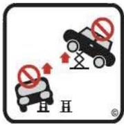
Не поднимайте автомобиль с одной стороны. Автомобиль может перевернуться, и/или может произойти повреждение подъемника
