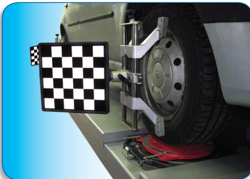
В отличие от традиционных стандов «развал-схождения», в которых используются многочисленные внешние электронные компоненты, в случае стандов 3D на колеса автомобилей устанавливаются пассивные мишени. Мишени для своей работы не требуют ни кабелей, ни источников питания, ни зарядных устройств, ни прочих электронных компонентов, которым необходима периодическая калибровка. Мишени просты по конструкции, не содержат стекла и устойчивы к коррозии, что делает их чрезвычайно надежными.
