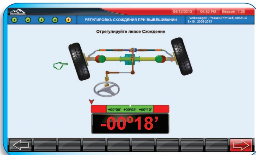
Удобно использовать в случае затруднения доступа к узлам регулировки развала.
